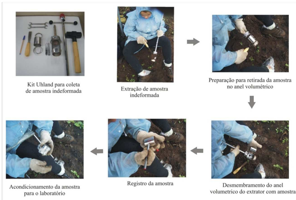
Figura 36: Seqüência de coleta de amostra indeformada. Arquivo pessoal, 2009.
