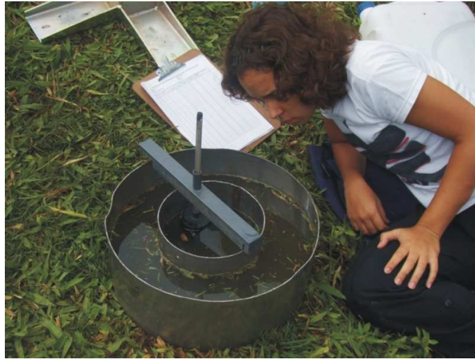
Figura 33: Leitura realizada no anel interno do infiltrômetro de anel duplo. Arquivo pessoal, 2009.
