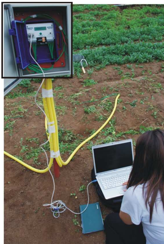
Figura 16: Datalogger Watermark modelo 900 capacidade de 8 sensores, 7 de potencial matricial e 1 de temperatura e sensor de matriz granular. Arquivo pessoal.
