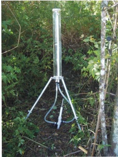
Figura 10: Permeômetro IAC (Instituto Agronômico de Campinas), utilizado pelo presente trabalho, arquivo pessoal.
