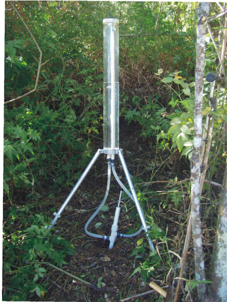
Figura 34: Permeômetro modelo IAC, mensuração da condutividade hidráulica saturada ( k_{sat} ), arquivo pessoal.
