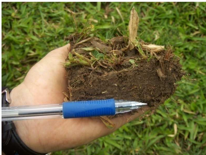
Figura 49: Adensamento da camada superficial da URHP, com redução da porosidade total.
